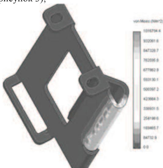
**Рисунок 3. Моделирование напряжений в детали типа «Кронштейн»**
