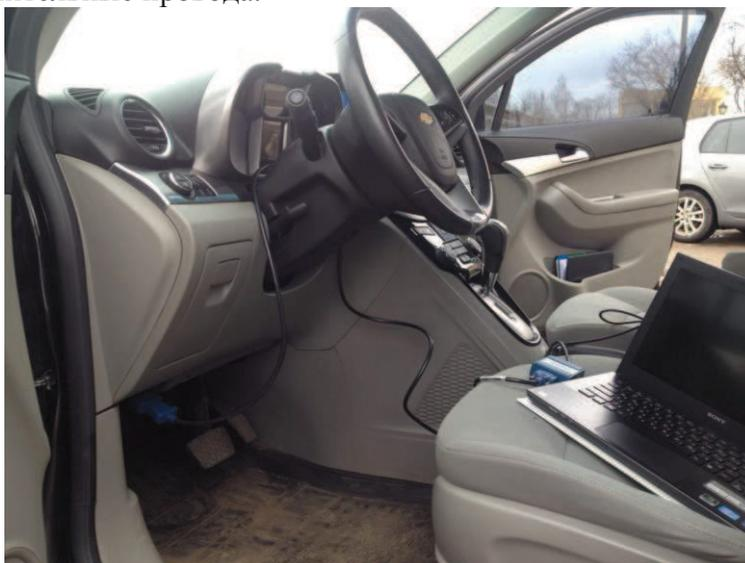
Рисунок 1. Подключение измерительного оборудования к автомобилю
