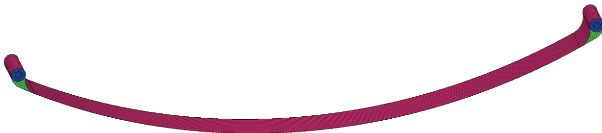
Рис. 2. Общий вид конечно-элементной модели рессоры.
