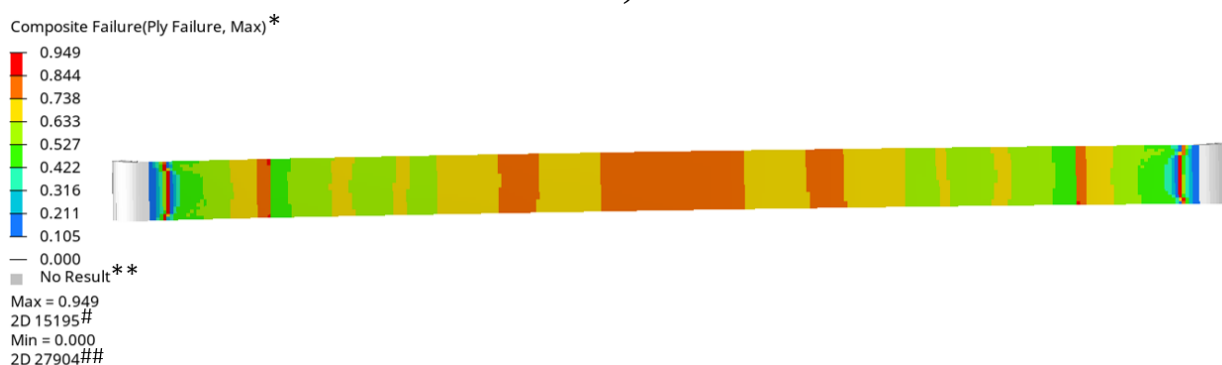
Рис. 12. Критерии разрушения рессоры: a — при статической нагрузке; b — при динамической нагрузке (*Критерий разрушения слоёв, максимальное значение, **Нет результата, #Двухмерный конечный элемент № 17061, ##Двухмерный конечный элемент № 27909 (англ.)).
