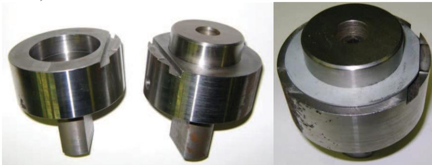
**Рисунок 4. Оснастка и установленный образец**
