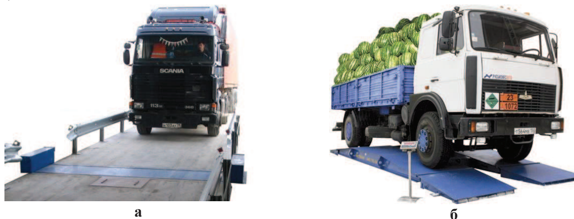
Рисунок 1. Измерение веса автомобилей: а) в динамике б) в статике
