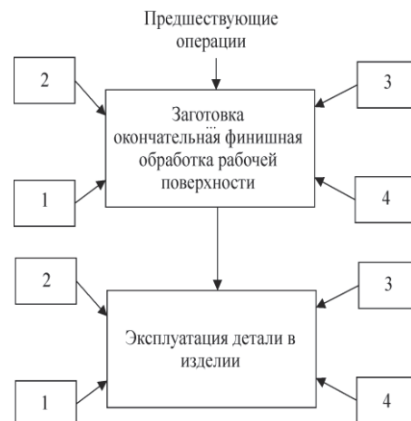
Рисунок 2. Структурная схема воздействия различных факторов на заготовку по окончательной обработке рабочей поверхности и при ее эксплуатации детали: 1, 2, 3, 4 – кинематическое, силовое, температурное и химическое воздействие на рабочую поверхность соответственно
