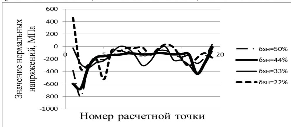
**Рисунок 4. Распределение значений нормальных напряжений на наружной поверхности внутренней заготовки в момент окончательного формообразования**
