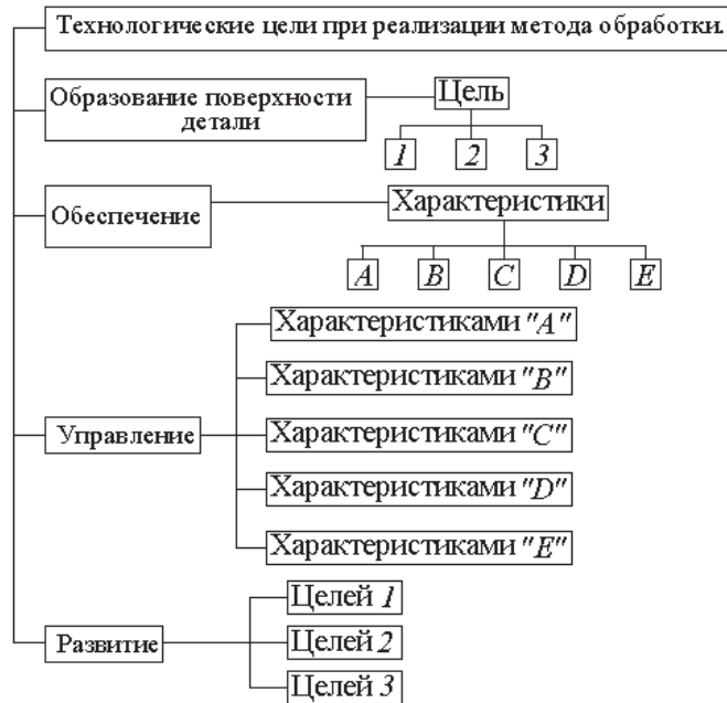
Рисунок 2. Структура технологических целей: 1 – min затрат; 2 – max производительности; 3 - заданного качества детали; А – статистические; В – динамические; С – инструмента; D – кинематические; Е – способа воздействия
