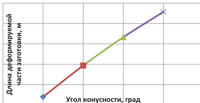
Рисунок 3. Изменение длины конического участка заготовки
