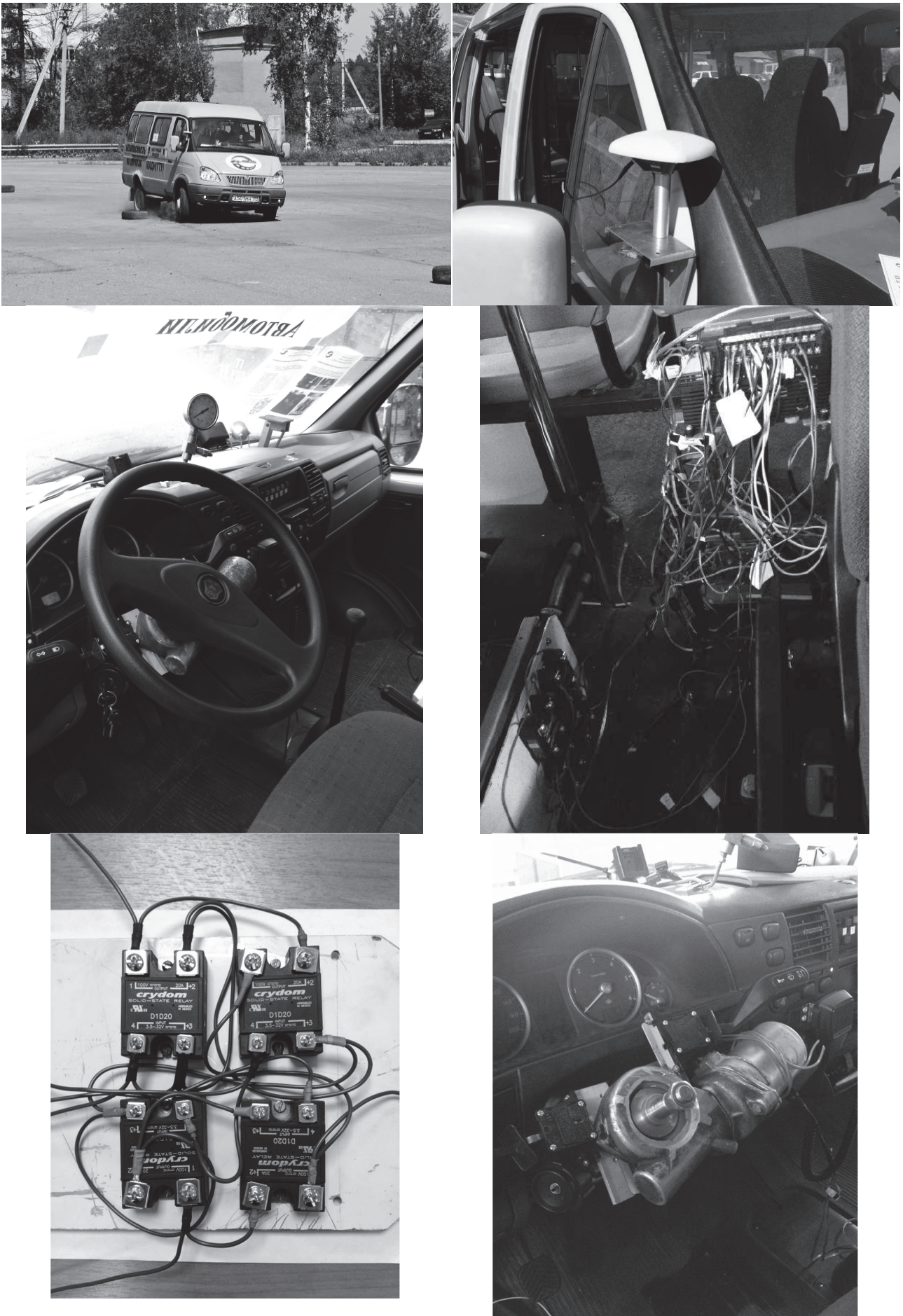
Рисунок 3. Элементы системы управления интеллектуального автомобиля
