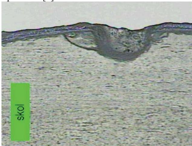
**Рисунок 8. Скол, образующийся на поверхности ситалла при обработке инструментом  $D=6$  мм**
