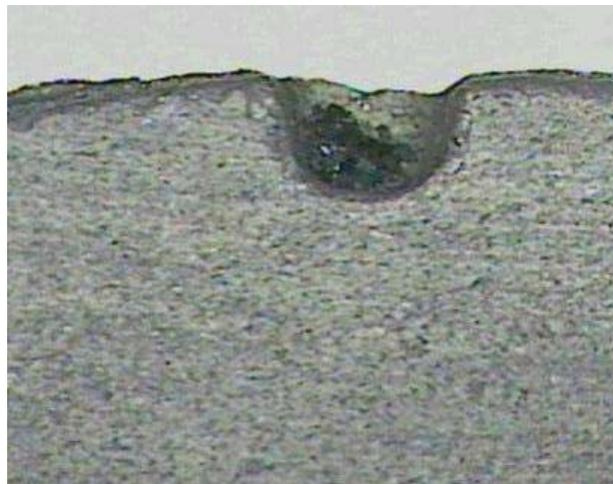
**Рисунок 9. Поверхность ситалла без сколов при обработке инструментом  $D=9$  мм**
