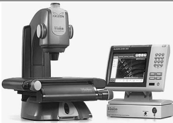
**Рисунок 6. Микропроцессор видеоизмерительный QC-300 Falcon**
