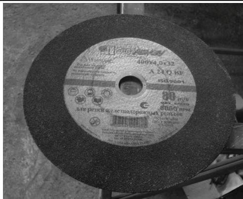
Рисунок 3. Круг отрезной на бакелитовой связке, армированный, рабочая скорость 80 м/с
