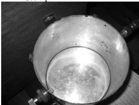
Рисунок 4 – Внешний вид исследуемого резонатора с колебаниями H_{011} и H_{013}
