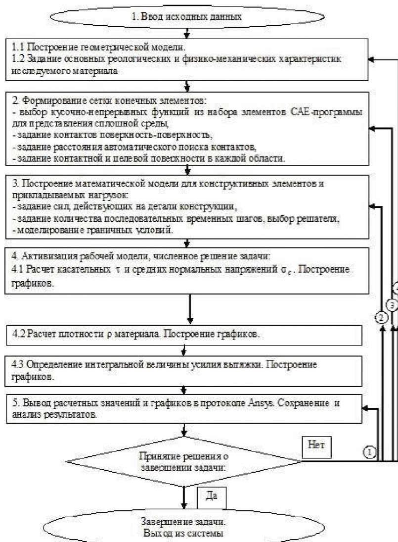
Рисунок 4 – Блок-схема методики инженерного расчета процесса формирования наноразмерных материалов в канале фильеры: 1 – проведение дополнительного анализа, 2 – оптимизация компьютерной программы, 3 – улучшение вычислительного алгоритма, 4 – расширение физической модели
