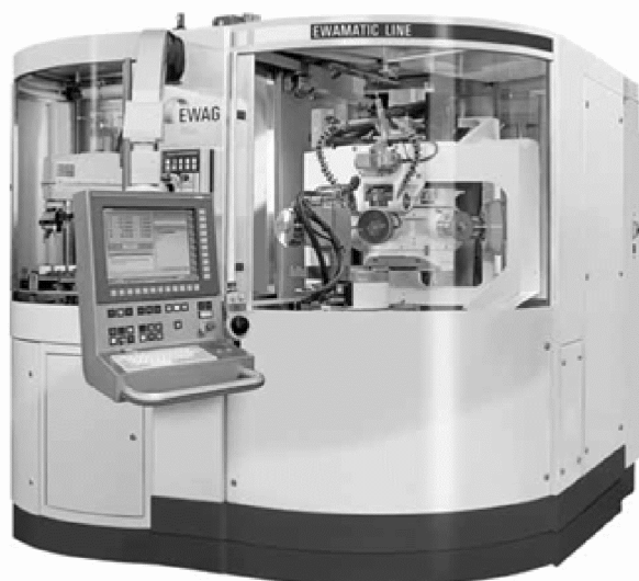
Рисунок 3 – Прецизионный шлифовально-заточной станок RS 15 (Швейцария)
