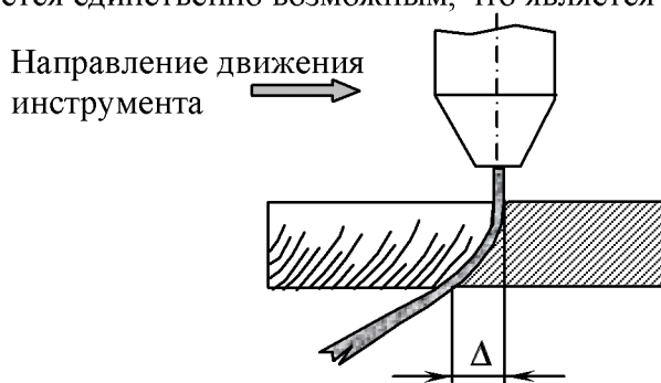
Рисунок 2 – Проявление эффекта «заноса» гидроабразивной струи
