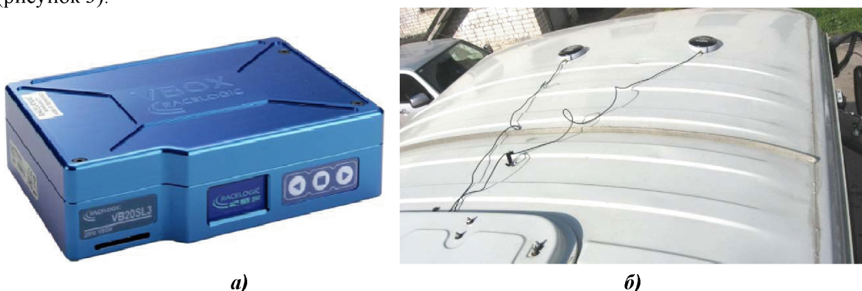
Рисунок 2 – Измерительный комплекс RaceLogic: а – блок сбора данных системы RaceLogic; б – схема установки антенн на крыше автобуса
