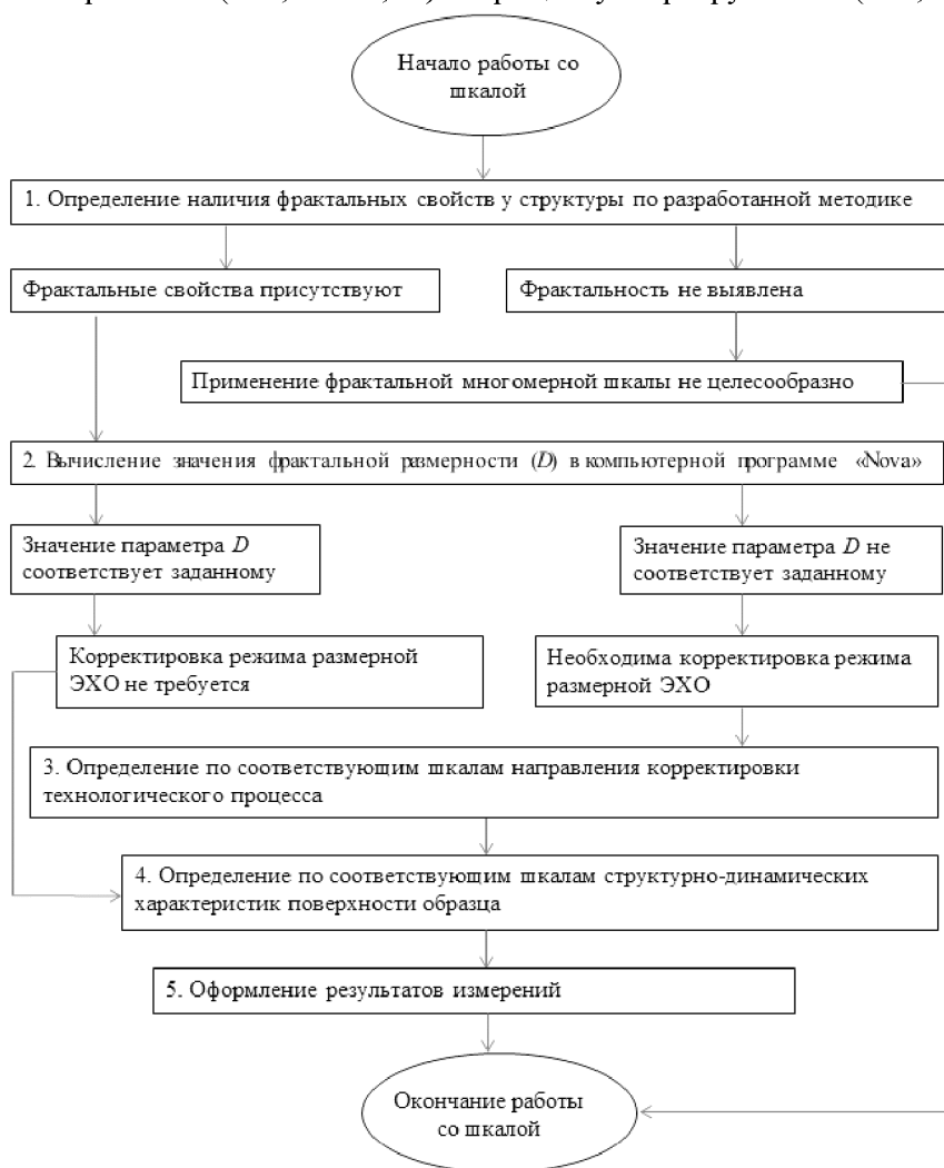
Рисунок 1 – Общий алгоритм применения многомерной шкалы
