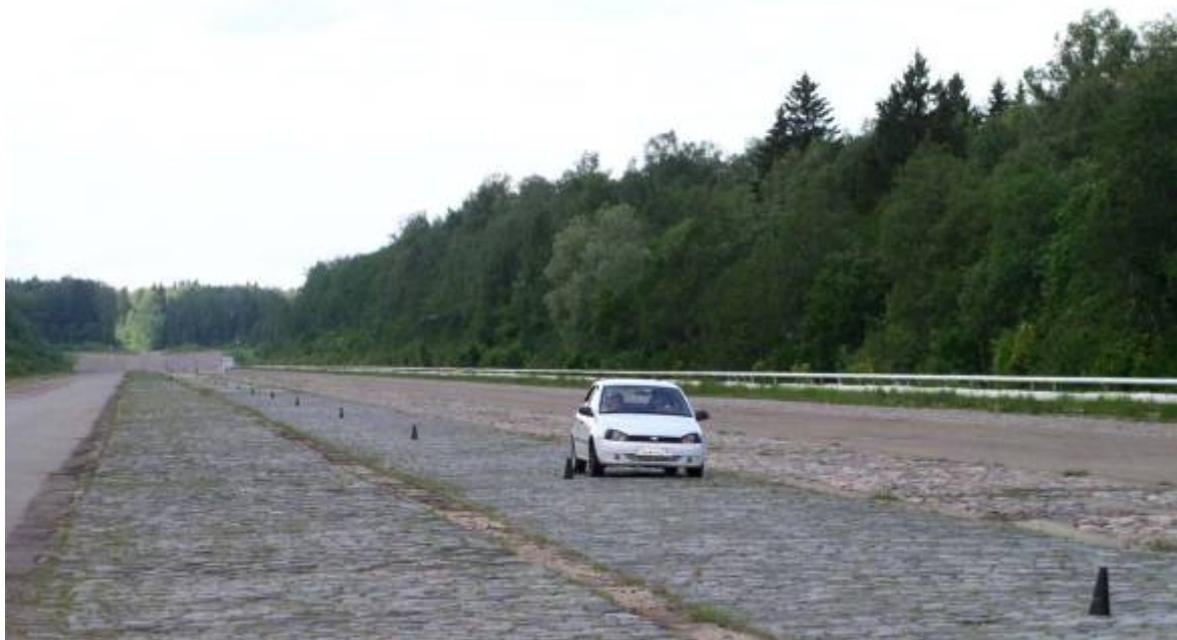
**Рис. 4. Выполнение маневра "Синусоида" в условиях булыжного покрытия.**
