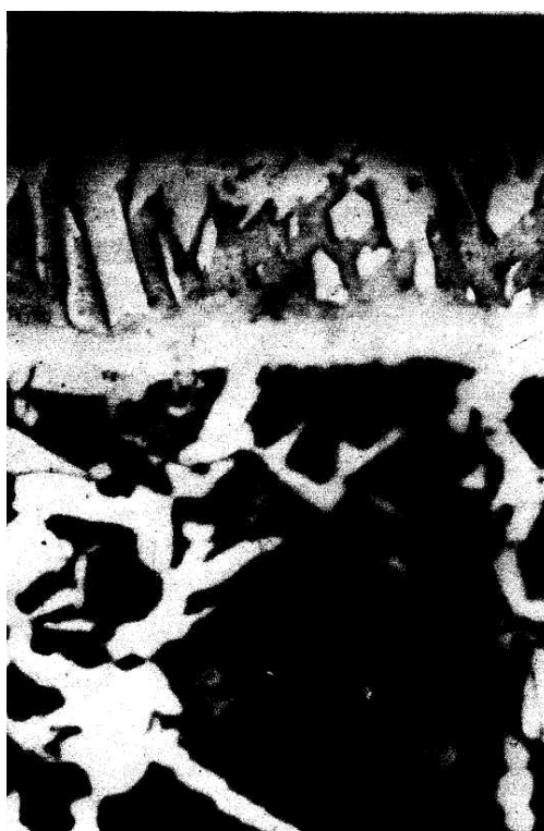
Рисунок 2 - Микроструктура хромированного диффузионного слоя
