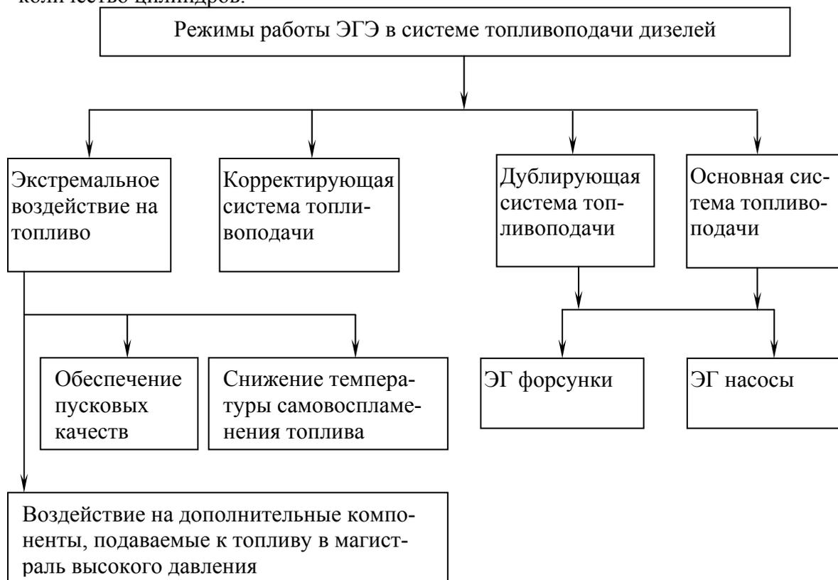
Рис. 1. Классификация электрогидравлических устройств в системе топливоподачи дизелей
