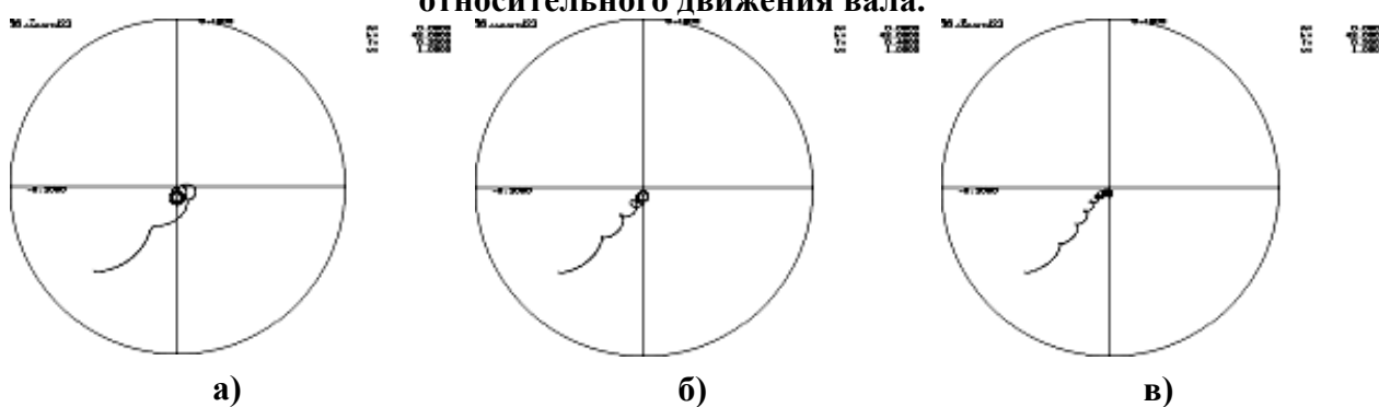
Рис. 5. Влияние коэффициента трения скольжения в точке контакта на характер траектории относительного движения вала.
