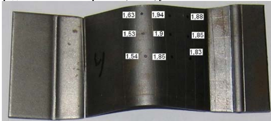
Рис. 12. Образец № 4 с проставленными толщинами, ширина у вершины составляет 45,15 мм, посередине наклонной грани 45,93 мм, у основания наклонной грани 46,78 мм.
