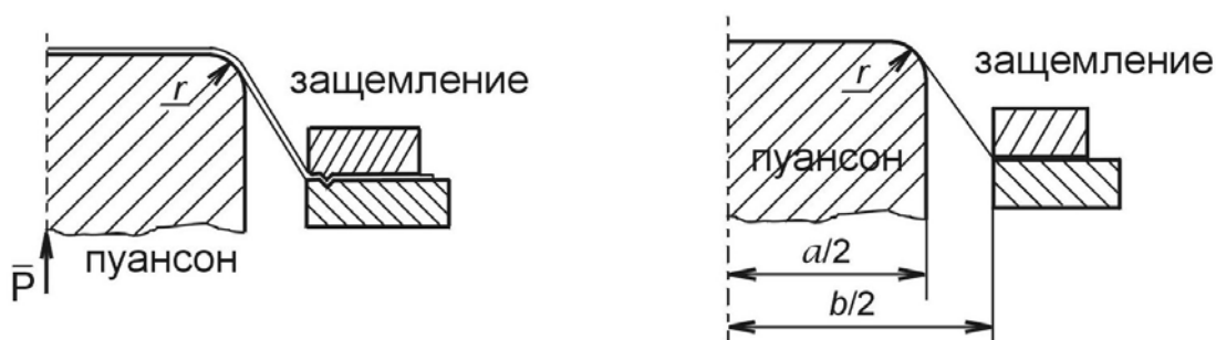
Рис. 1. Схема формовки пуансоном квадратного сечения
