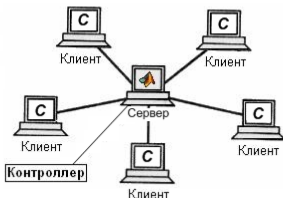
Рисунок 6 - Схема взаимодействия приложения C и среды MATLAB по топологии «Звезда»
