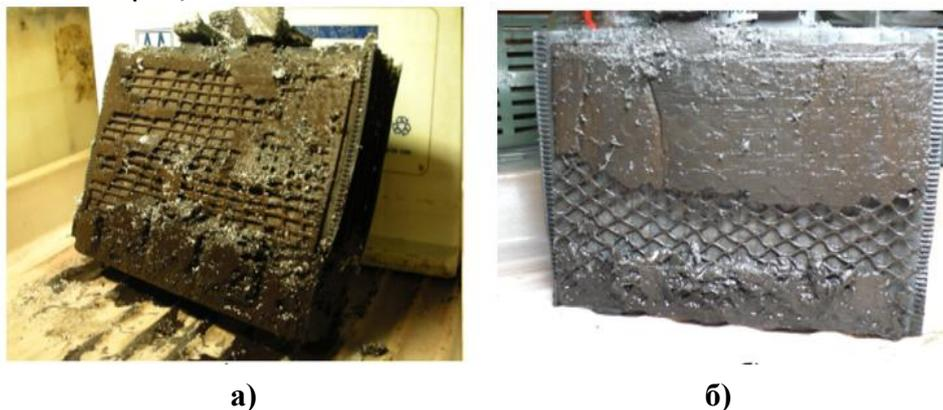
Рисунок 4 – Разрушение активной массы положительных электродов: а) АКБ 6СТ-55 «MUTLU Mega Calcium»; б) АКБ 6СТ-55 «RENAULT»
