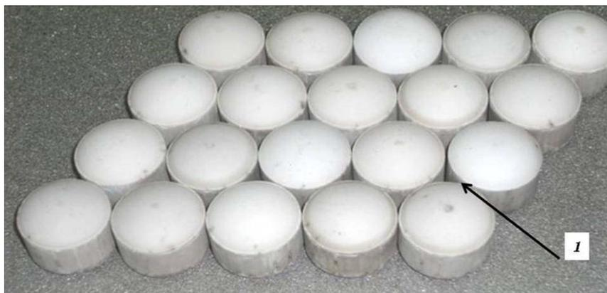
**Рисунок 2 – Керамические (корундовые) элементы дробяще-отклоняющего слоя:
