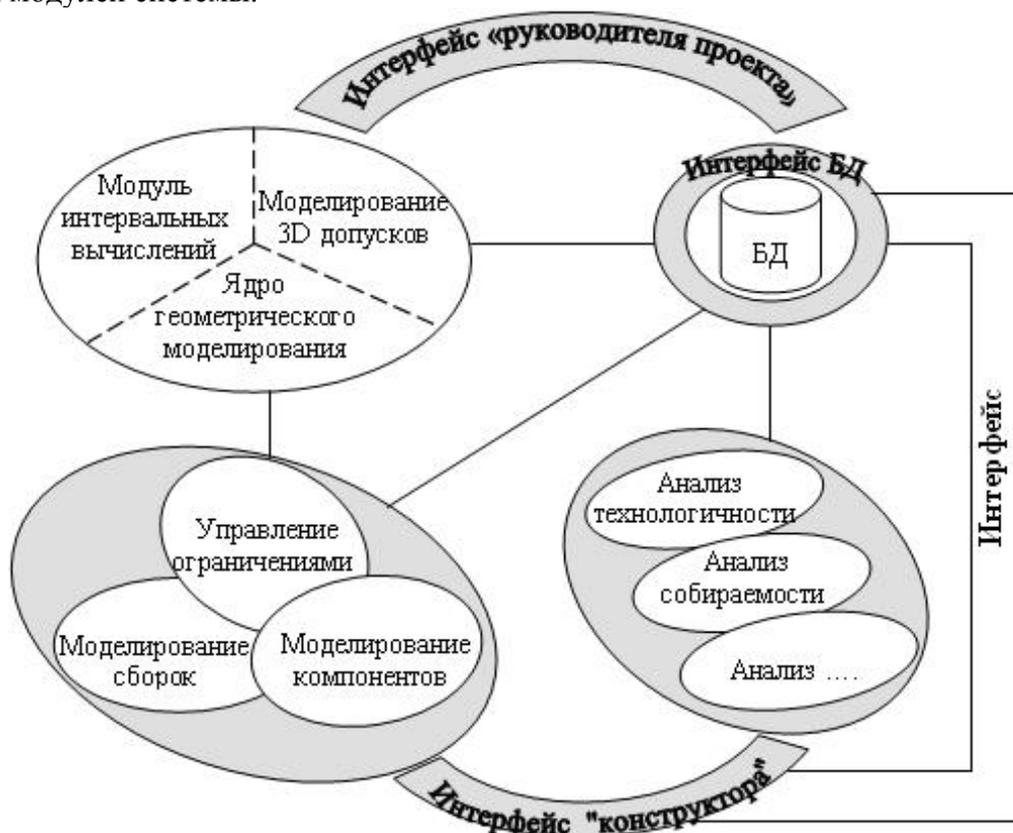
Рис. 1. Архитектура CAD системы.
