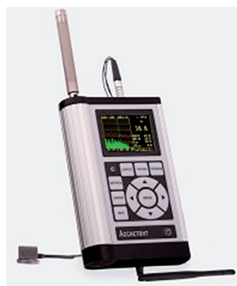
Рис. 5. Вибро- и шумоизмерительный комплекс «Ассистент»
