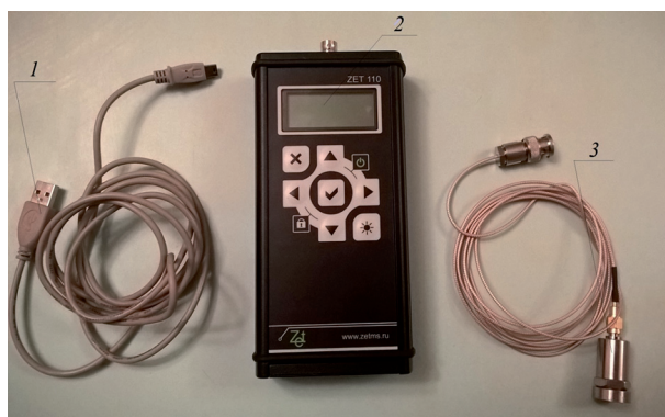
Рис. 4. Вибро- и шумоизмерительный комплекс ZETLAB:
