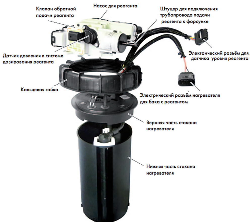
Рис. 2. Подающий AdBlue модуль с системой подогрева и подачи реагента к форсункам дизельного ДВС Volkswagen tdi-25-l-evro-5 ( V_h = 2,5 л, N_e = 120 кВт)
