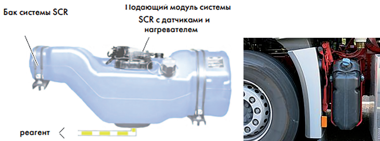
Рис. 3. Подогреваемые баки хранения мочевины AdBlue , применяемые на автомобилях категории N1 и N3
