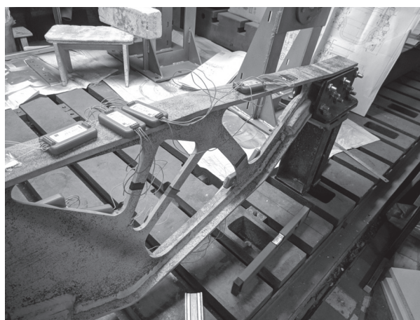
Рис. 13. Балансир с тензорезисторами, регистрирующей аппаратурой и нагрузочным устройством
