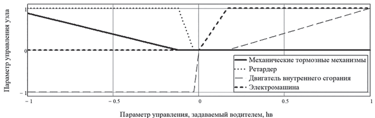
Рис. 12. Срез поверхностей отклика системы распределения тяговых/тормозных моментов (температура ОЖ находится в норме, накопитель энергии полностью заряжен)
