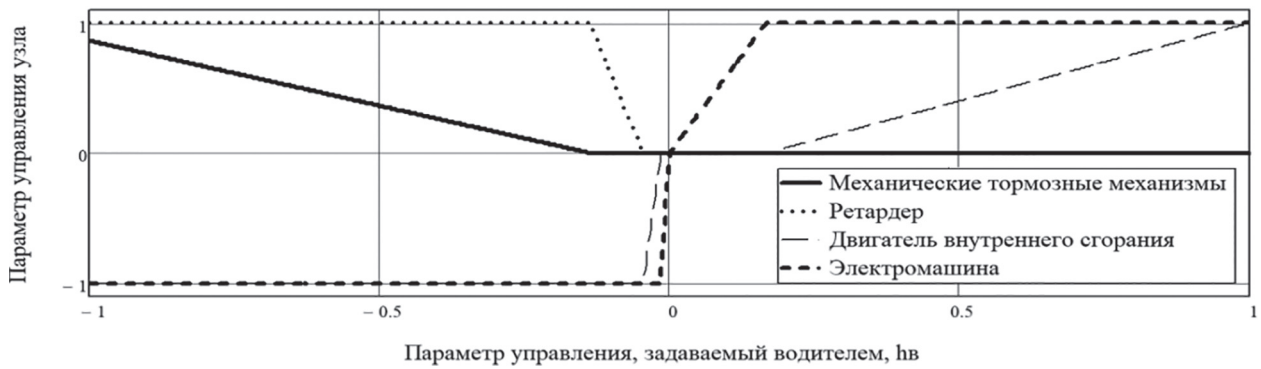
Рис. 10. Срез поверхностей отклика системы распределения тяговых/тормозных моментов (системы работают в штатном режиме – температура ОЖ находится в норме, накопитель энергии частично заряжен)
