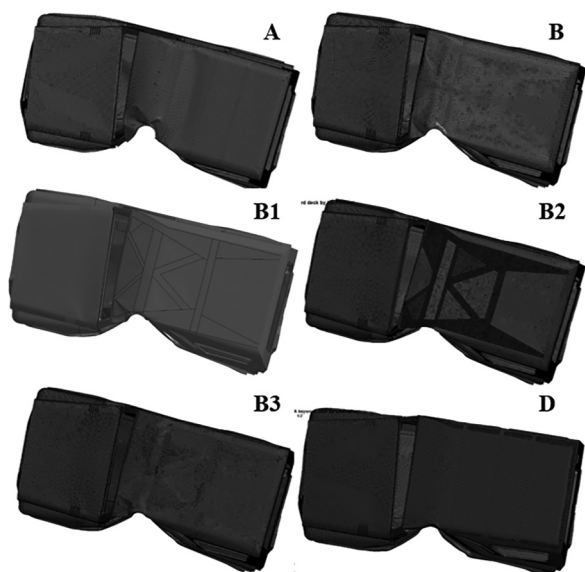
Рис. 13. Деформированное состояние кузова для вариантов А, В1,2,3 и D
