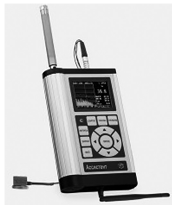
Рис. 5. Вибро- и шумоизмерительный комплекс «Ассистент»
