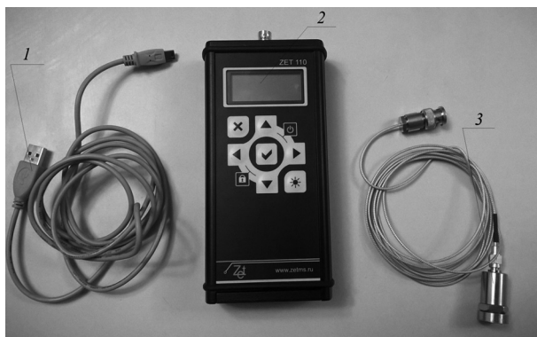
Рис. 4. Вибро- и шумоизмерительный комплекс ZETLAB:
