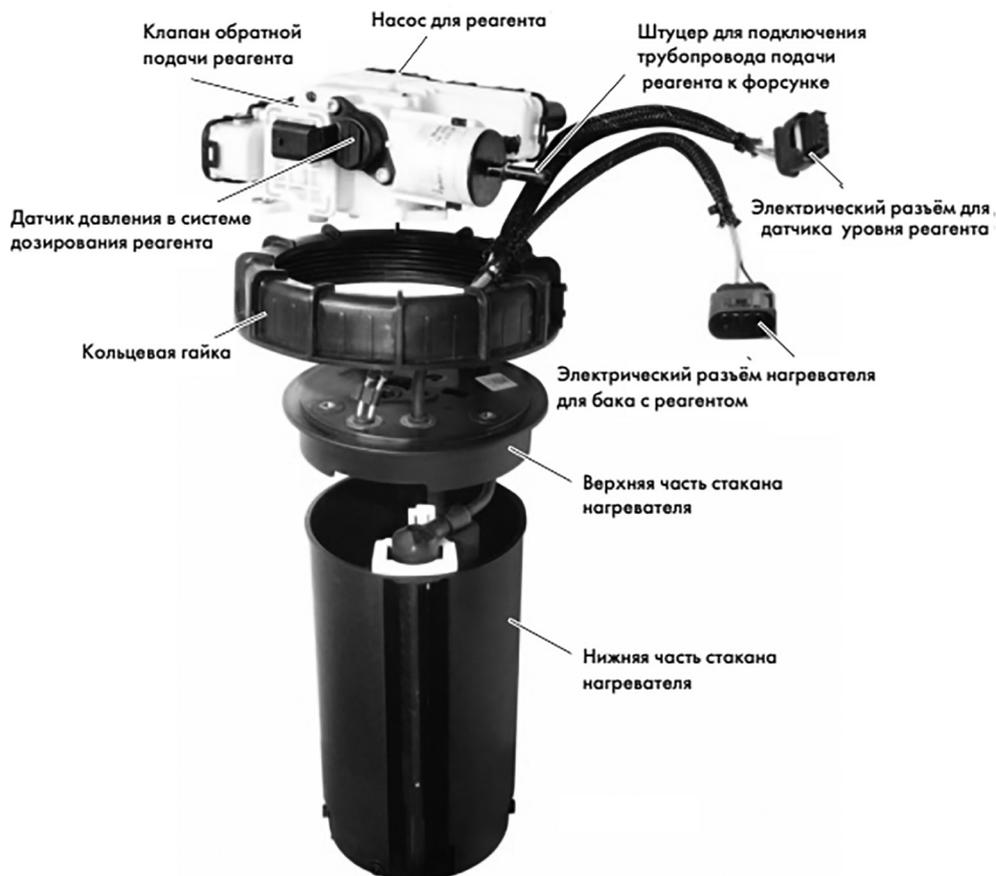
Рис. 2. Подающий *AdBlue* модуль с системой подогрева и подачи реагента к форсункам дизельного ДВС *Volkswagen tdi-25-l-etro-5* ( $V_h = 2,5$  л,  $N_e = 120$  кВт)
