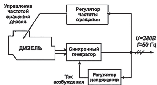
Рис. 2. Схема ДГУ с устройством регулирования частоты вращения первичного двигателя
