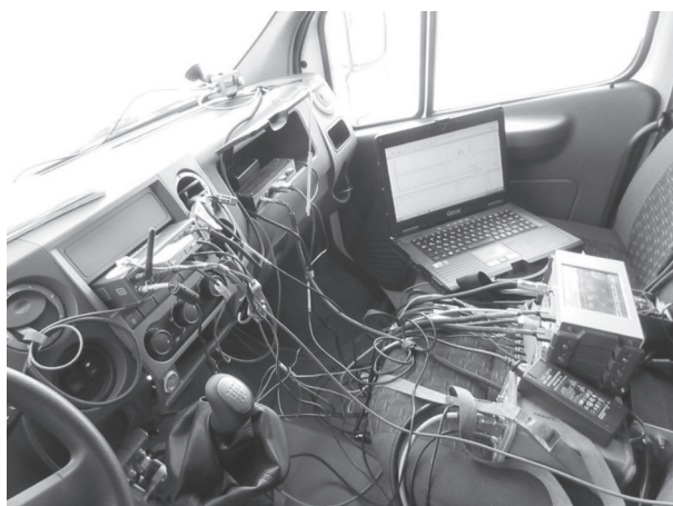
Рис. 5. Установка измерительного оборудования в кабине
