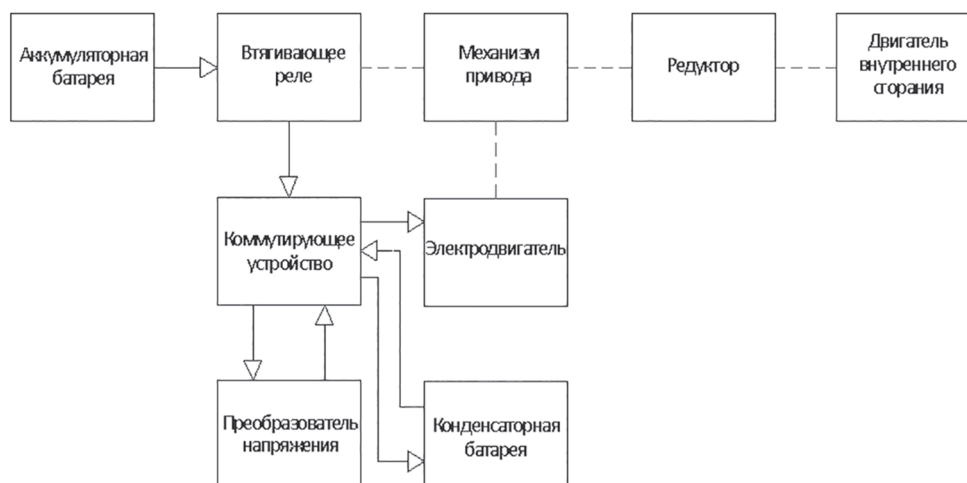
Рис. 1. Структурная схема системы электростартерного пуска с конденсаторной батареей
