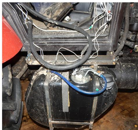
Рис. 4. Система питания трактора для работы на МКБТК
