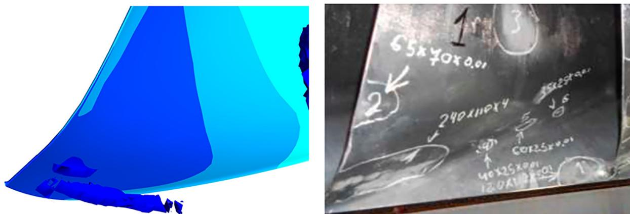
**Рис. 6.** Сопоставление области возникновения паровой фазы, полученной в расчете, с местами повреждений от воздействия кавитации на всасывающей кромке рабочего колеса
