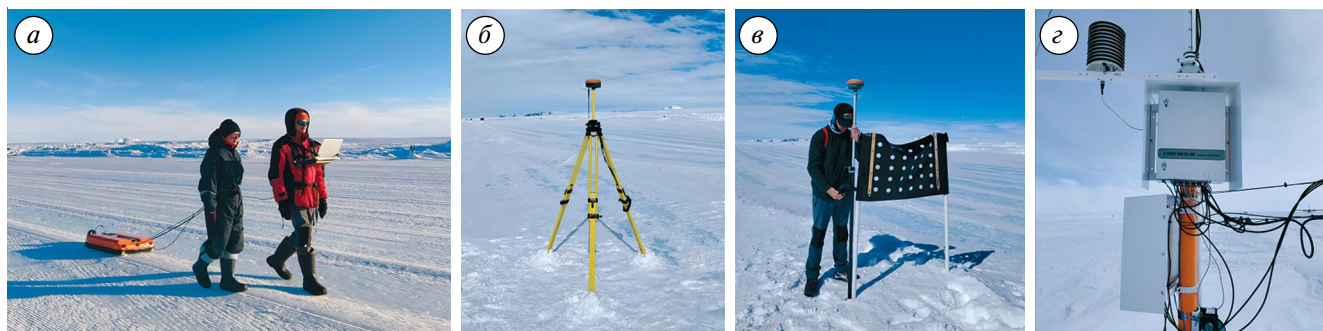
Рис. 2. Выполнение работ в районе посадочной площадки: съёмка георадаром ОКО-3 с антенной 150 МГц (а); базовая станция EFT M2 (б); измерения ровером EFT M2 (в); автоматическая метеостанция Milos 520 (г)
