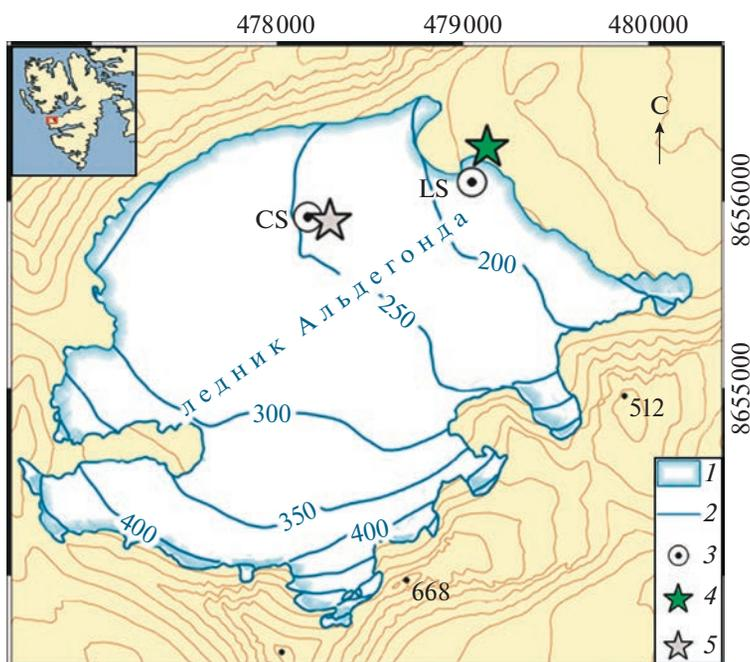
**Рис. 1.** Расположение ледника Альдегонда и измерительная сеть на нём: 1 – контур ледника (2021 г.); 2 – изолинии высоты поверхности (2018 г.); 3 – площадки для измерения абляции льда; 4 и 5 – постоянная и временные метеорологические станции.
