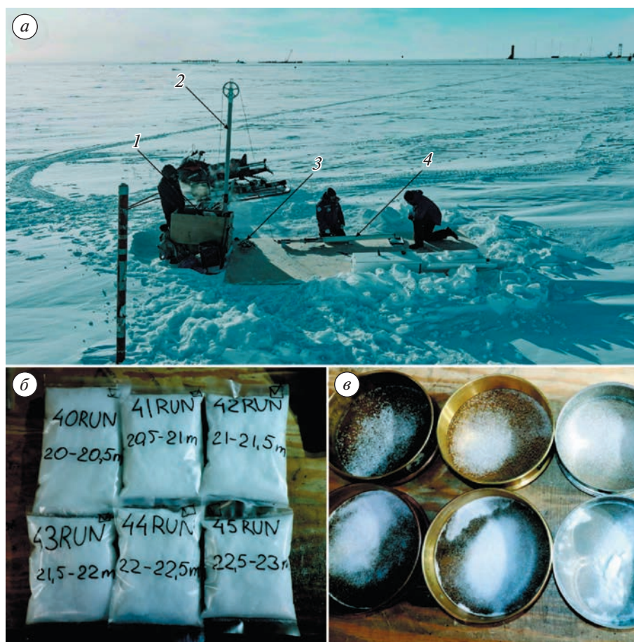
Рис. 1. Экспериментальные работы на станции Восток в сезоне 67 РАЭ: а – буровая площадка скважины VK-22 ситовой анализ: 1 – лебедка и её электропривод в сборе; 2 – буровая мачта с кронблоком; 3 – устье скважины; 4 – буровой снаряд; б – ледяной шлам с различных интервалов бурения; в – ледяной шлам, рассеянный на лабораторных ситах.
