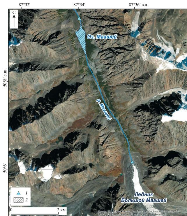
**Рис. 1.** Схема выполнения полевых работ: 1 — пункты отбора проб воды на изотопный анализ; 2 — территория, охваченная тахеометрической съёмкой. На заднем плане спутниковый снимок World-view 2 на 5.09.2021 (подложка программы ArcMap 10.4.1 (ESRI Inc., USA))
