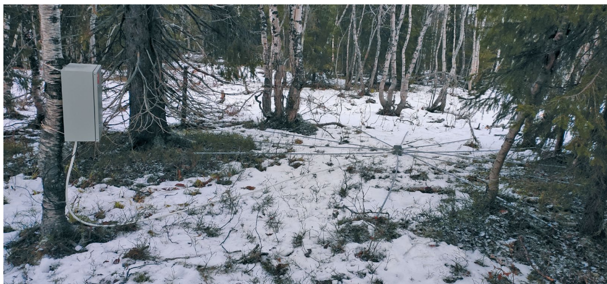
Рис. 5. Станция инфразвукового мониторинга РАВГ: камера с низкочастотным микрофоном МРА-201, оснащённая пространственным фильтром ветровых помех. Фото А.И. Воронина, 20.11.2020
