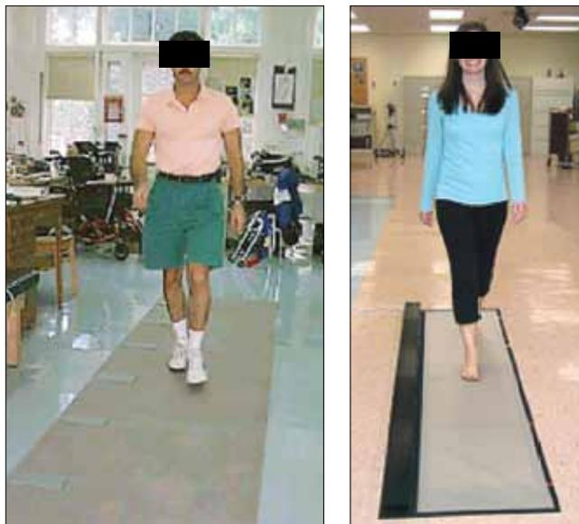
Рис. 1. На фото слева комплекс «GAITRite», справа «Walkway™ System» компании «Tekscan».
