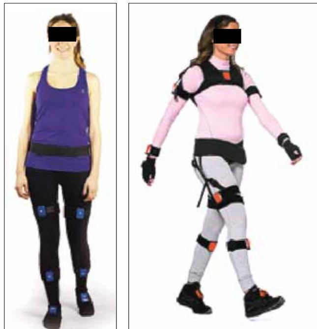
Рис. 6. Комплексы анализа движений с инерционными сенсорами. Слева – STT Systems, справа – Xsens.
