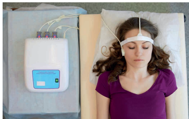
Рис. 1. Измерение перфузии в ходе проведения исследования с помощью неинвазивного оптического прибора «Вазотест» Fig. 1. Measurement of perfusion during the study using a non-invasive optical device «Vasotest»
