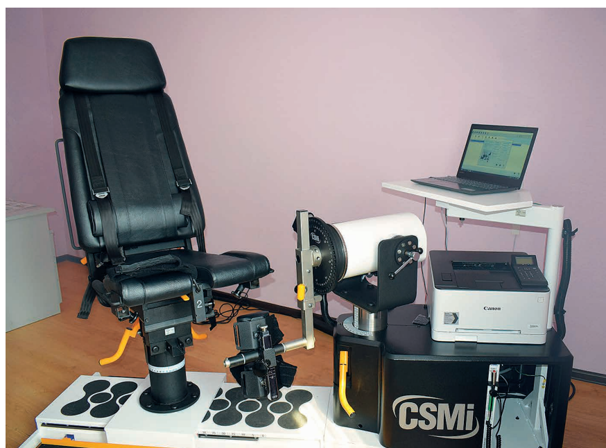
Рис. 1. Биомеханическая лечебно-диагностическая система Humac Norm (CSMi Medical Solutions, США) Fig. 1. Biomechanical treatment and diagnostic system Humac Norm (CSMi Medical Solutions, USA)
