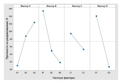
Рисунок 2 — График влияния основных эффектов факторов на средние значения прочности на раздавливание таблеток ГМЛ-1
