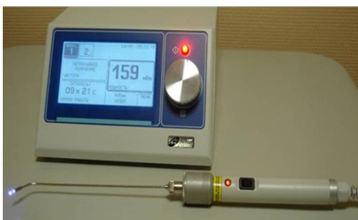
Рис.1. Излучатель малой мощности: блок питания и сменный светодиодный излучатель с длиной волны 405 нм
