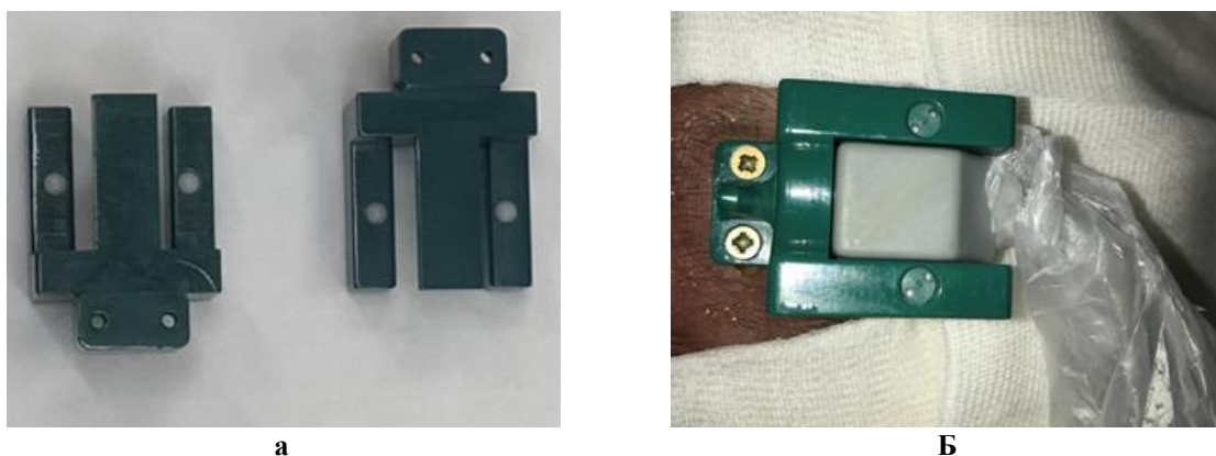
Рисунок 3 (а) – датчик, регистрирующий положение инструмента, (б) – датчик, регистрирующий положение инструмента фиксирован к черепу.
