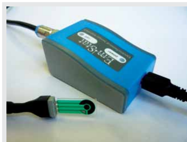
Рис. 5. Прототип биоаналитического устройства для анализа метаболической активности клеток в составе портативного электрохимического анализатора (Em Stat, Palm Instruments) и одноразового печатного электрода
