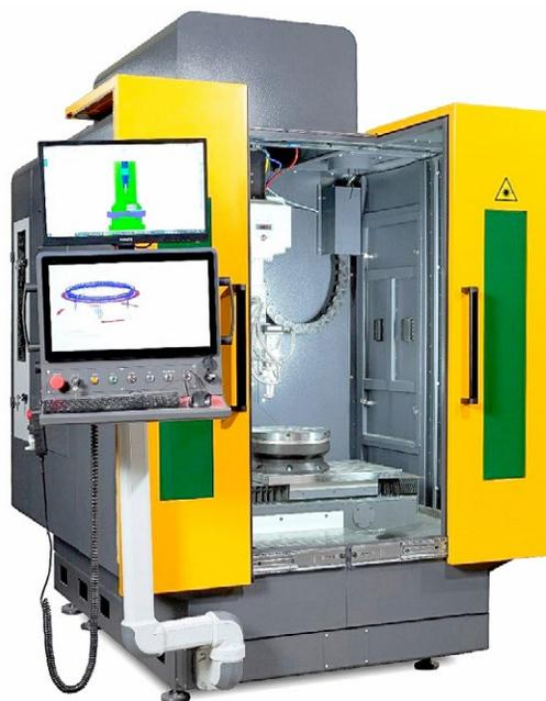
**Рис. 1.** Серийная установка пятикоординатной лазерной обработки СЛП520.
