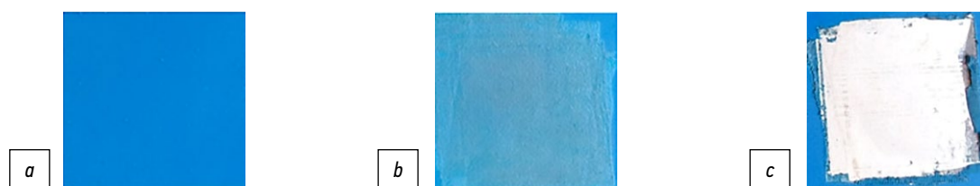
Рис. 3. Макроморфология участков (площадью по 4 см 2 ) с лакокрасочного покрытия алкидного типа (со средней толщиной 120 мкм), сфотографированных до и после лазерной очистки в режимах с разными параметрами: a — поверхность лакокрасочного покрытия до лазерной очистки; b — частично очищенная поверхность после лазерной очистки в режиме 2 по табл. 2; c — полностью очищенная часть поверхности после лазерной очистки в режиме 4 по табл. 2.
